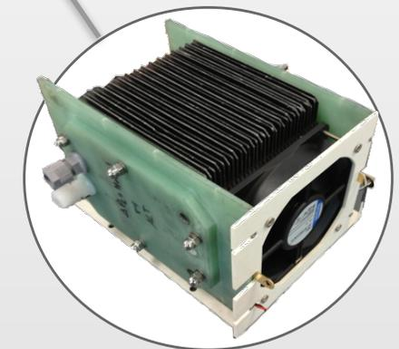
In mobilen Verkauf-Caddy integrierte Brennstoffzelle, H<sub>2</sub>-Speicher und elektrischem Zwischenspeicher.
